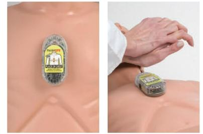
Bisher stehen nur Kraft- und Drucksensoren zur Verfügung. Die neue Technik des PocketCPR umfasst einen Beschleunigungsmesser und einen hoch entwickelten Verarbeitungsalgorithmus. Dieses System misst exakt die CPR-Kompression und wandelt die Bewegung des Beschleunigungsmessers in eine Weginformation um. Rettungskräfte und CPR-Schulungsleiter haben nun das ideale Werkzeug zur Hand, mit dem sich die CPR-Durchführung und -Schulung erleichtern und verbessern lassen.
